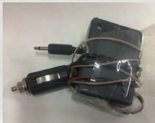
Ajopiirturin väärennyslaite, joka kytketään ajopiirturiin ja tupakansytyttimeen.
