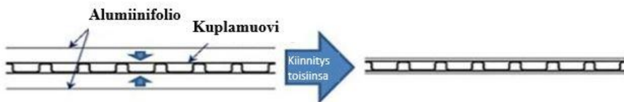
Kuva 3, rakenne sivusta katsottuna
